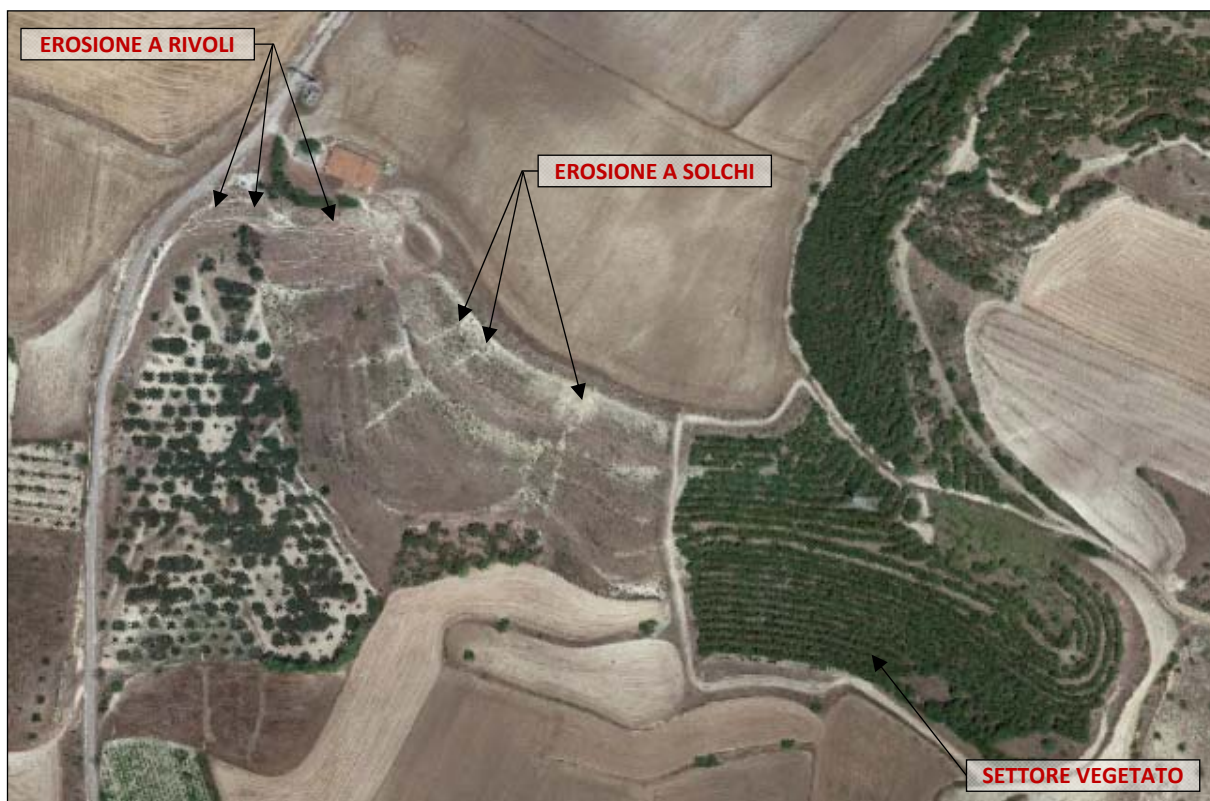
Figura 5.2 – Erosione a solchi visibile da immagine aerea di Google nel versante meridionale in località Genna Serra a nord dell’abitato di Guamaggiore. Detti fenomeni risultano notevolmente più ridotti nel settore orientale dello stesso versante, procedendo verso Selegas, per la presenza della vegetazione
